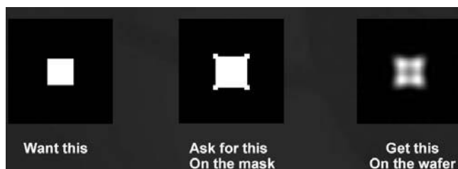
Obr. 9: Optické korekce na masce. Vlevo požadovaný motiv, uprostřed korekce masky, vpravo výsledný motiv. (zdroj: [3])
